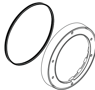
Verlängerung 22 mm (bei geringer Einbautiefe)
